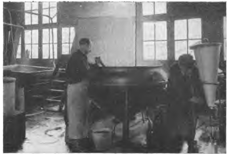
FIG. 152. — Extraction des alcaloïdes végétaux par macération et filtration.
