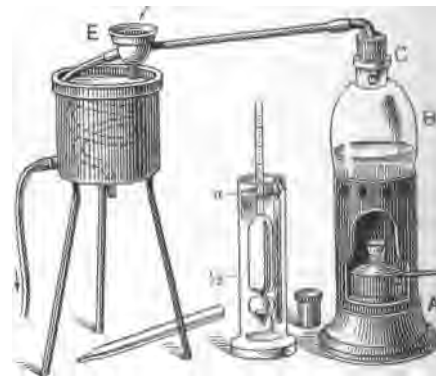
FIG. 159. — Alambic Salleron-Dujardin. A. Lampe-foyer ; B. Ballon ; C. Bouchon ; E. Serpentin. (Les flèches indiquent le trajet de l'eau de réfrigération.)
