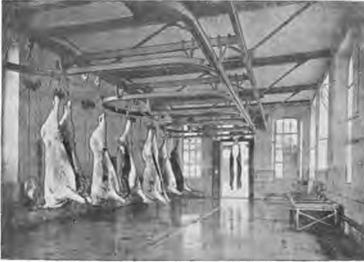
FIG. 12. — Partie d'une halle d'abatage du gros bétail dans un abattoir de ville de moyenne importance. Un dispositif spécial permet le déplacement facile et rapide des quartiers de viande.
