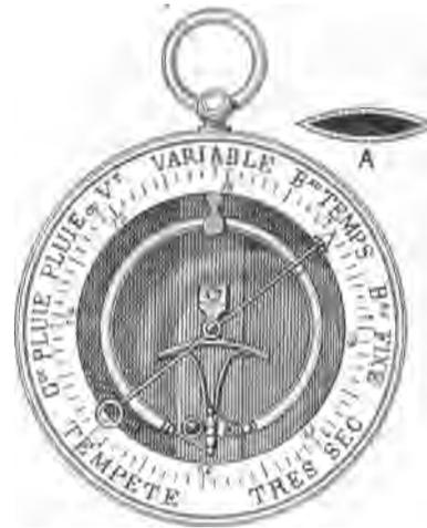
FIG. 474. — Baromètre anéroïde
