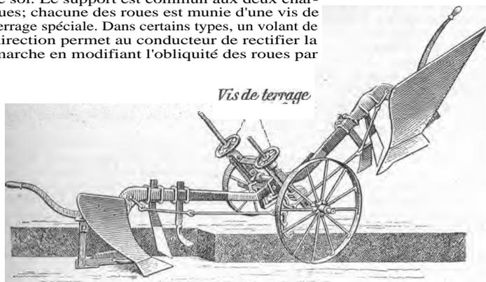
FIG. 973. -- Charrue défonceuse (type balance).
