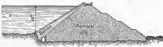
FIG. 1108. — Digue-réservoir.
