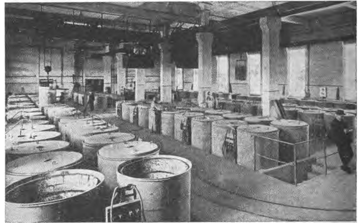
FIG. 1435. — Azotation du carbure de calcium (salle des fours électriques de la Société de cyanamide S.P.A.).
