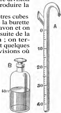
FIG. 1663. — Burette hydrotimétrique. A. Burette; B. Flacon.
