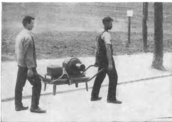
FIG. 1796. — Petit moteur électrique monté sur civière. Deux hommes peuvent facilement le transporter au point où il devra être utilisé.
