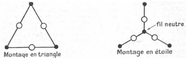
FIG. 1806. — Distribution de courant alternatif triphasé avec trois fils et avec quatre fils.
