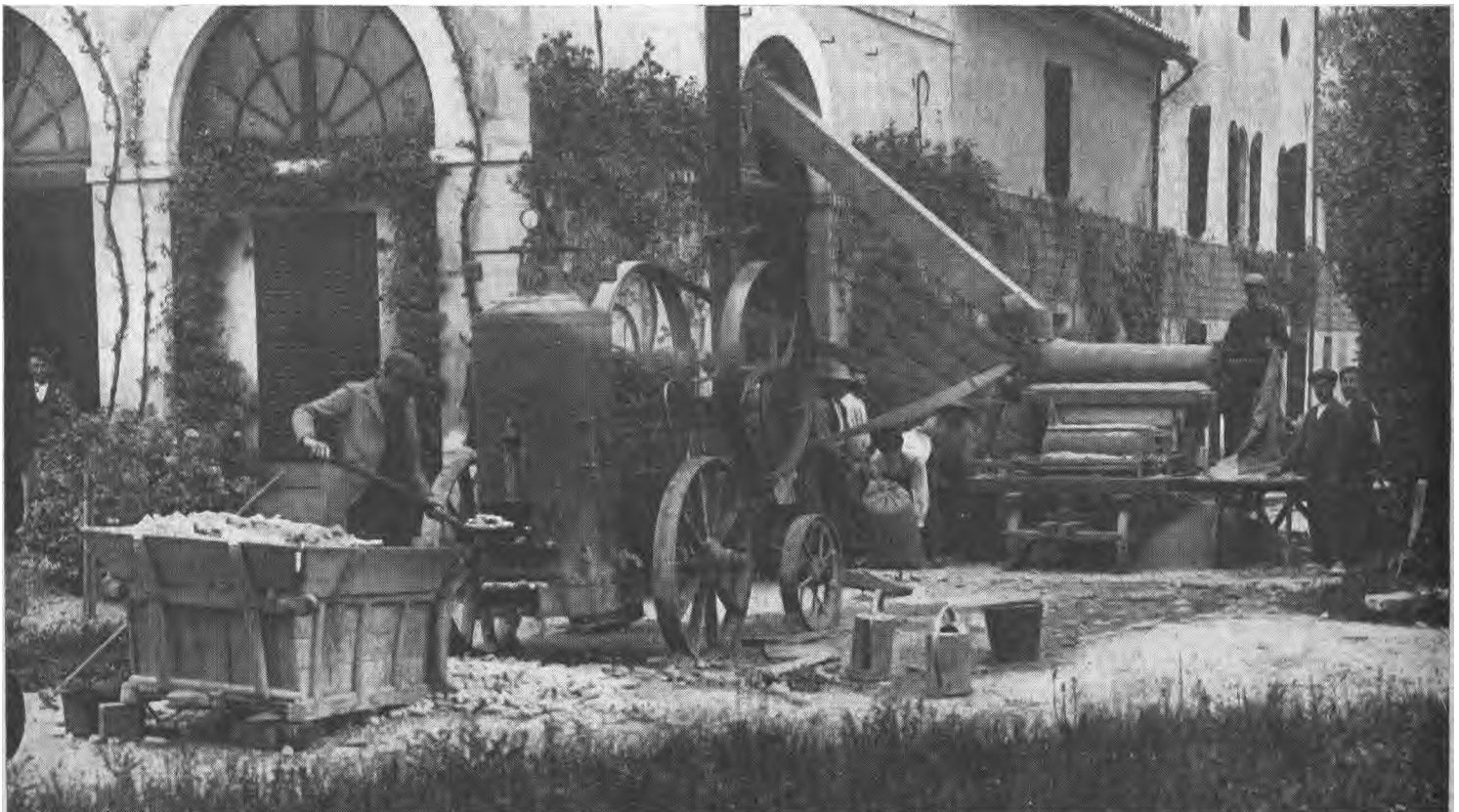
FIG. 1774. — Égrenage mécanique du maïs. (Le chauffage du moteur est obtenu avec les résidus de l'égrenage.)
