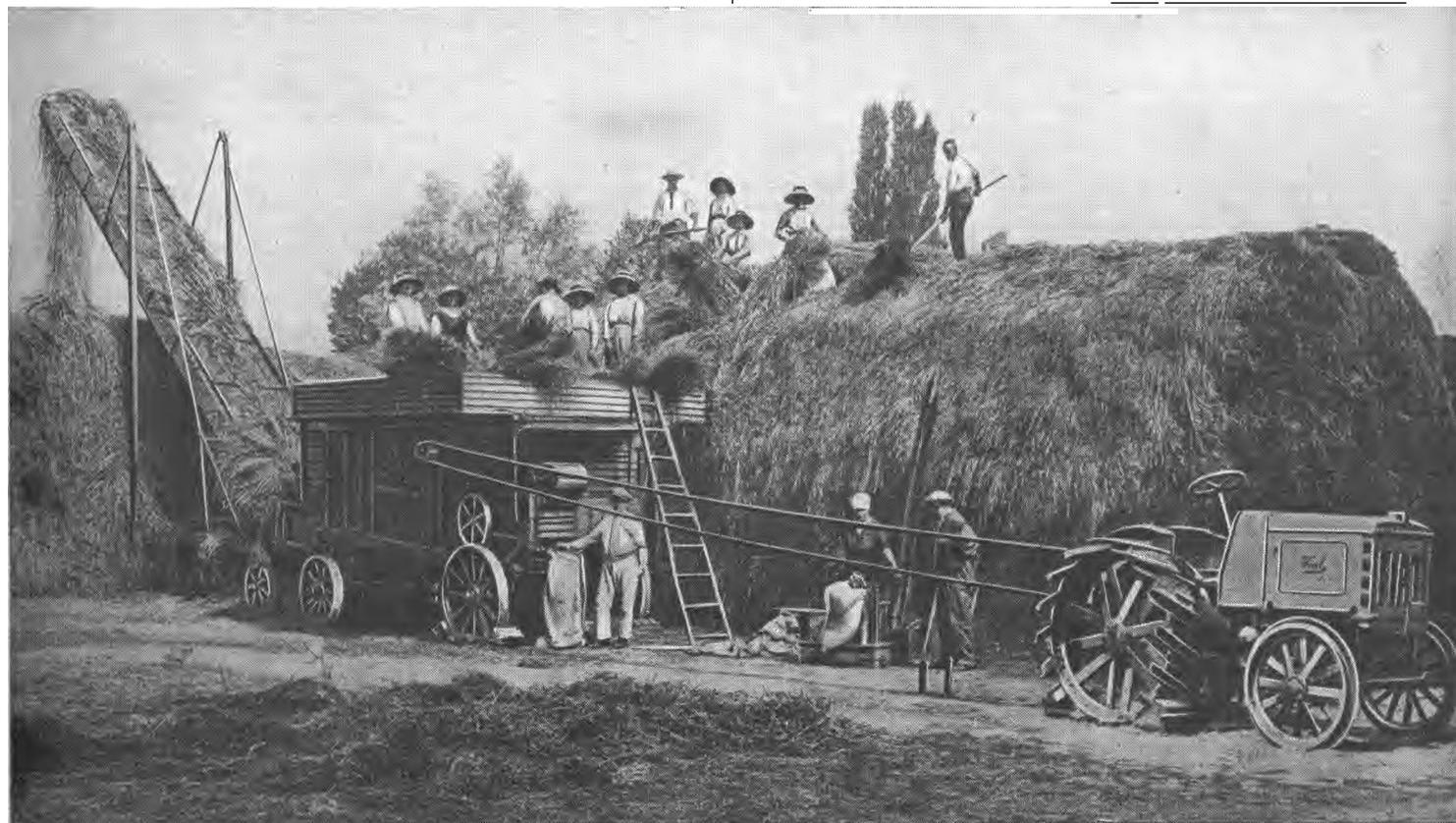
FIG. 1830. — Batteuse à grand travail munie d'un *élévateur de paille* et actionnée par un tracteur agricole. L'élévateur de paille fonctionne automatiquement, ce qui permet de faire le travail, jusques et y compris le pesage et l'ensachage du grain, avec 12 à 15 personnes.
