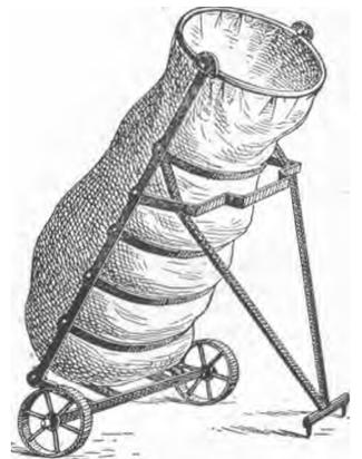
FIG. 1879. — Ensacheur à brouette.
