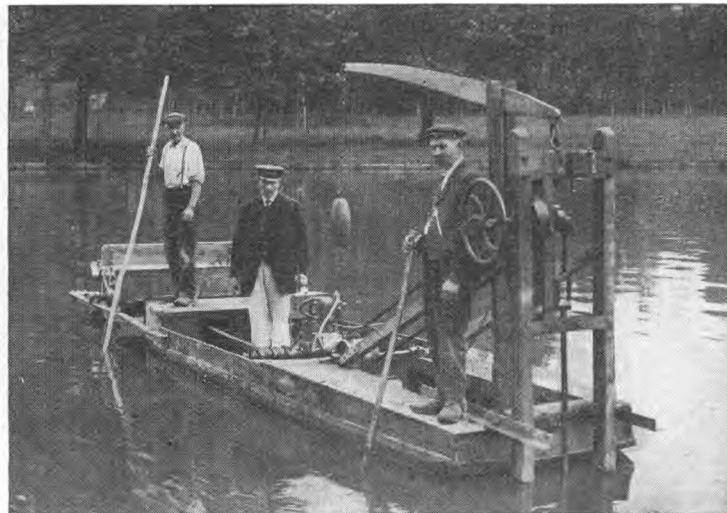
FIG. 2054. — Bateau faucheur automobile en marche.
