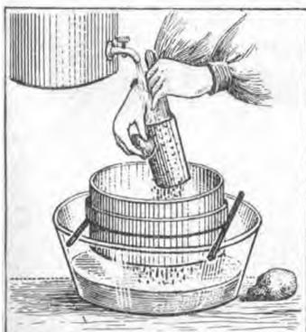
FIG. 2073. — Principe de l'extraction de la fécula de pommes de terre.
