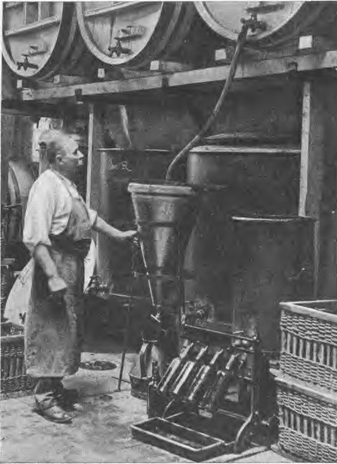
FIG. 2137. — Filtrage des vins après pasteurisation.
