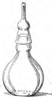
FIG. 550. Ballon de Pasteur pour cultures microbiennes.
