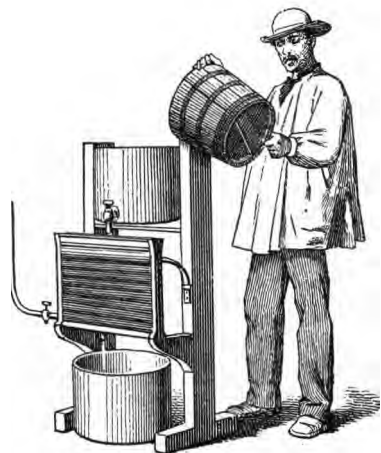
FIG. 476. — Réfrigérant employé pour retarder la maturation de la crème en été.
