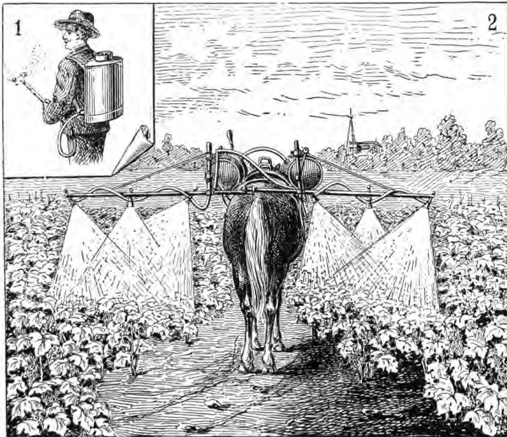
FIG. 562. — Traitement du mildiou par épandage de bouillies cupriques. 1. Pulvérisateur à jet double; 2. A grand effet.
