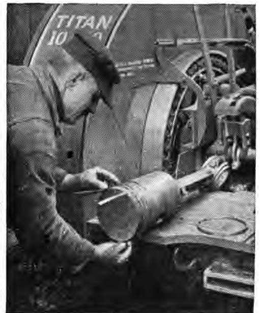
FIG. 622. — Manière de placer les segments au moyen de trois bandes de feuilard.
