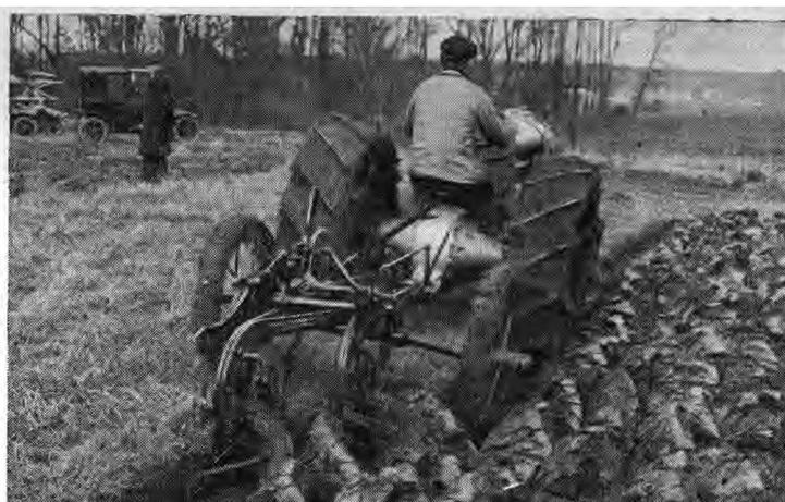
10. — Tracteur à deux roues motrices, type carter-châssis (Fordson).
