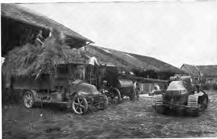
7. — Commande d'une batteuse avec un tracteur (Renault).
