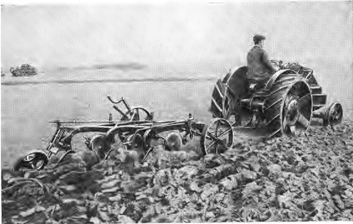
1. — Charrue à relevage automatique (Renault) avec réglage par manivelle et vis sans fin (tracteur Renault, à deux roues motrices).
