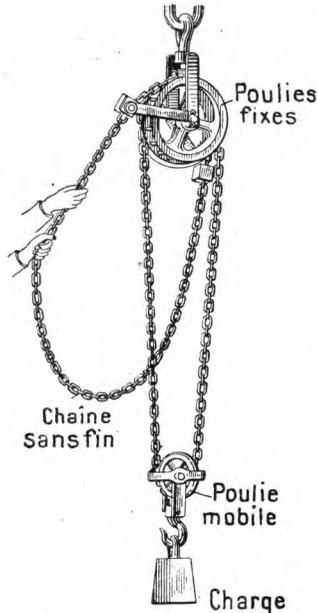
FIG. 940. Palan en fonctionnement.
