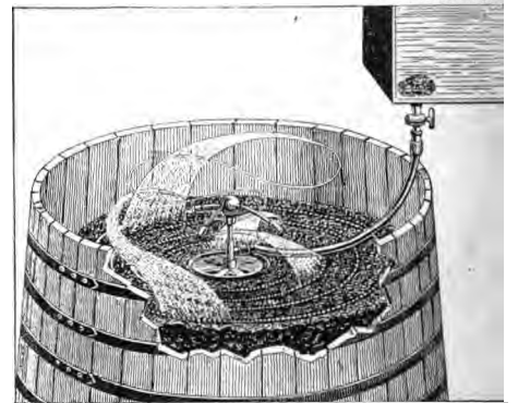
FIG. 1162. — Arrosoir automatique Pépin pour la fabrication en grand des piquettes.
