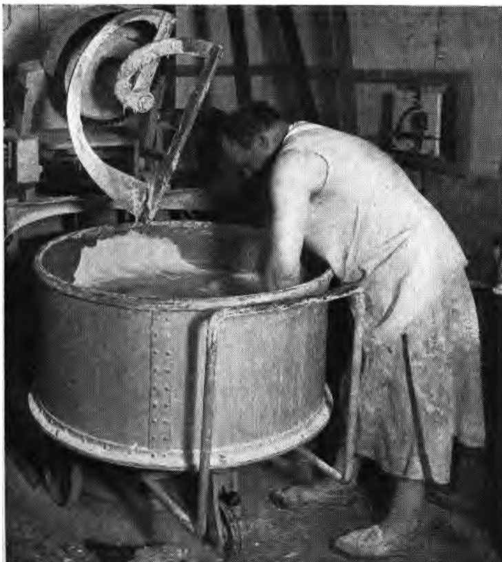
FIG. 1083. — Pétrin avec l'agitateur hélicoïdal relevé.
