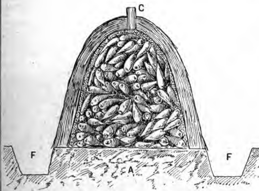
5. — Silo temporaire à betteraves à l'air libre, conique. F, F. Caniveaux d'assainissement ; C. Cheminée d'aération ; A. Sol.
