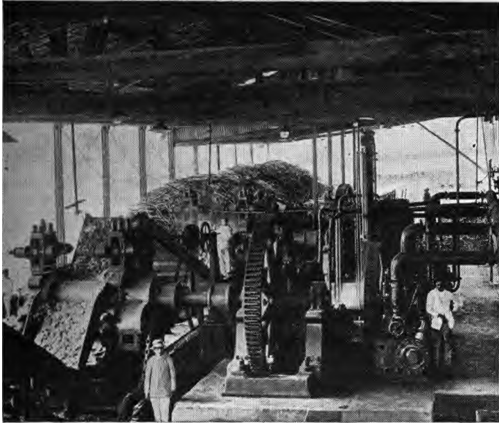
1. — Sucre de canne. Broyage des cannes dans des moulins à cylindres.
