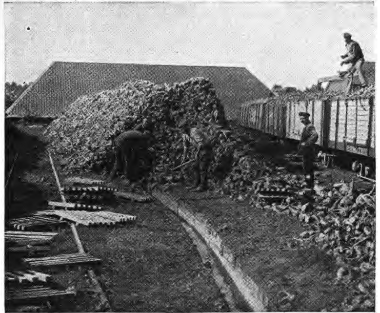
2. — Sucre de betterave. Arrivée des betteraves à l'usine. Transporteur hydraulique.
