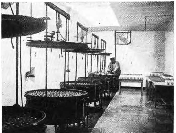
FIG. 1893. — Stérilisation du lait (procédé de Rothschild) à la ferme d'Arcy-en-Brie. (Batterie de stérilisateurs.)
