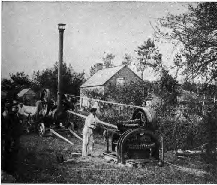
FIG. 2192. — Treuil de défoncement actionné par un moteur à vapeur.
