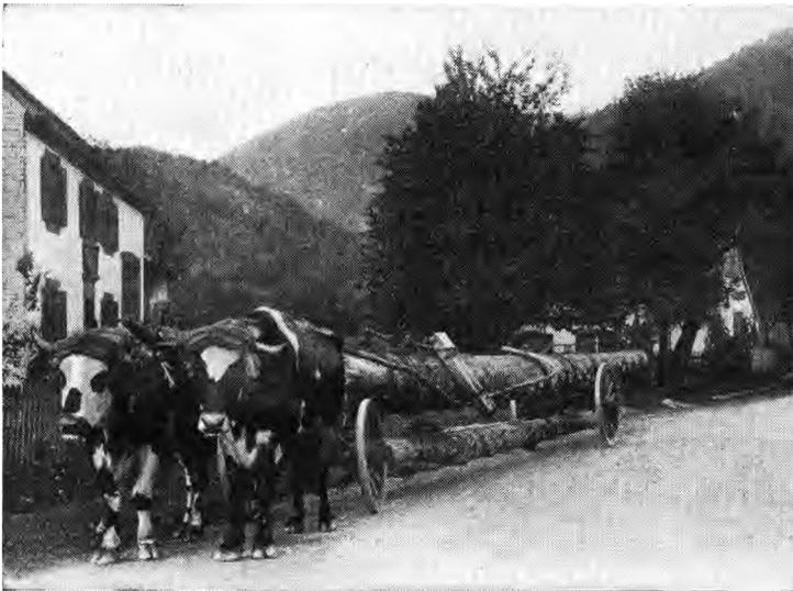
FIG. 2170. — Chariot à trains rompus pour le transport des pièces de bois en grumes.
