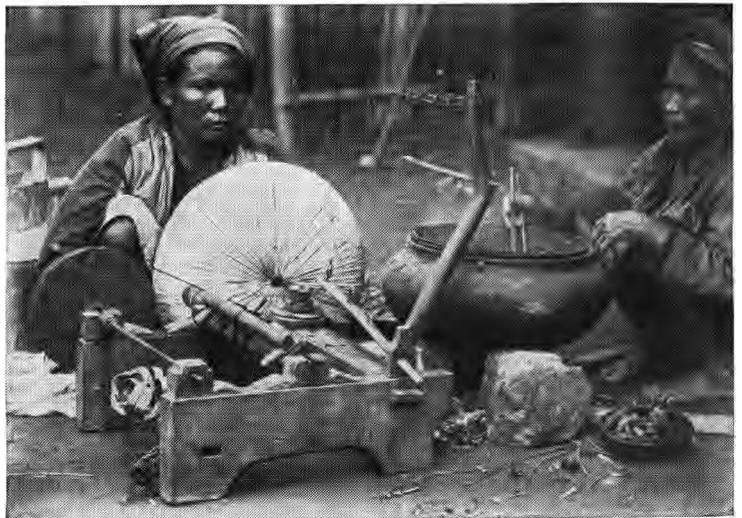
FIG. 2333. — Métier à dévider les cocons et dévideuses tonkinoises.
