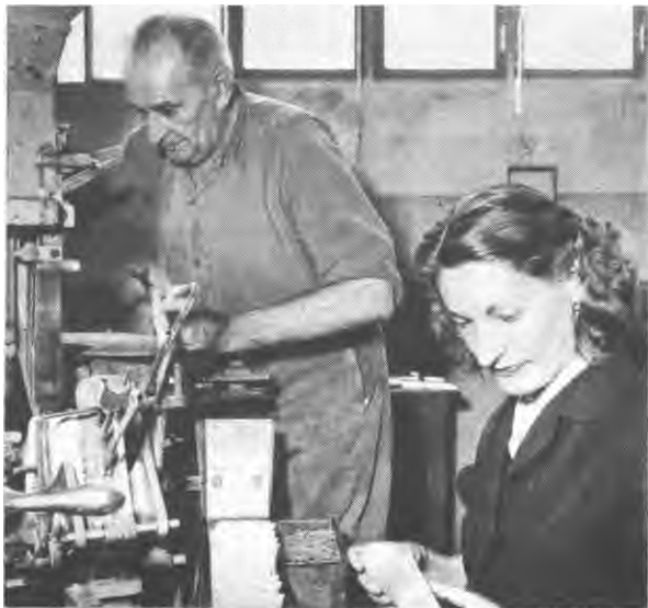
Réglage d'une machine pour le remplissage des sachets.
